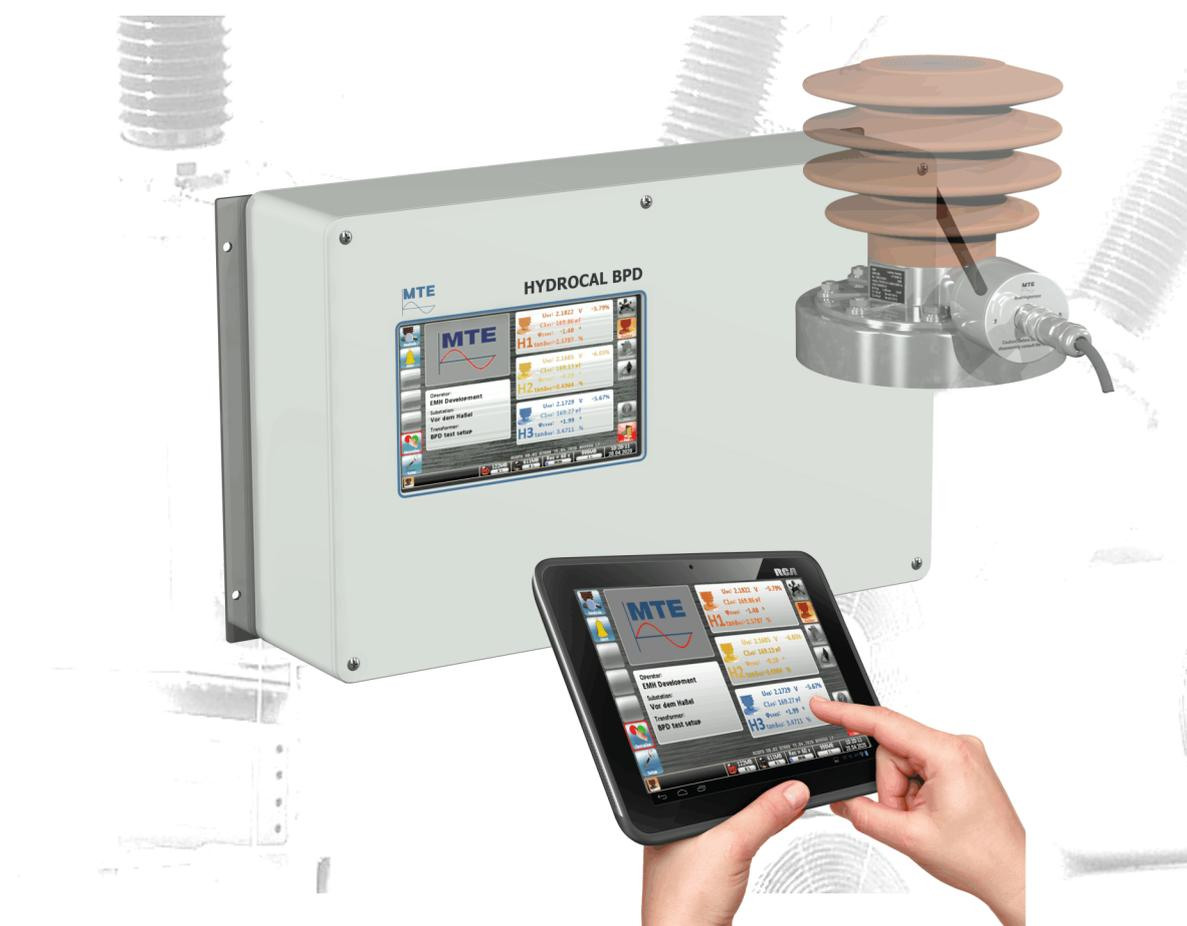
El HYDROCAL BPD es un sistema modular de monitoreo en línea para Bushings de alta tensión. Admite la medición de la tensión y el ángulo de fase en la toma de prueba para derivar  $\tan\delta$ /PF, capacitancia del Bushing.
