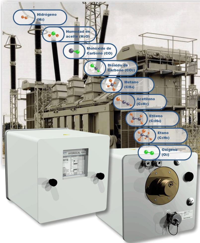
El HYDROCAL 1009 es un sistema de análisis de multi-gas-en-aceite instalado permanentemente con funciones de monitorización de transformadores. Permite la medida individual de humedad ( $H_2O$ ) y los gases claves Hidrógeno ( $H_2$ ), Monóxido de Carbono ( $CO$ ), Dióxido de Carbono ( $CO_2$ ), Metano ( $CH_4$ ), Acetileno ( $C_2H_2$ ), Etileno ( $C_2H_4$ ), Etano ( $C_2H_6$ ) y Oxígeno ( $O_2$ ) disueltos en el aceite del transformador.
