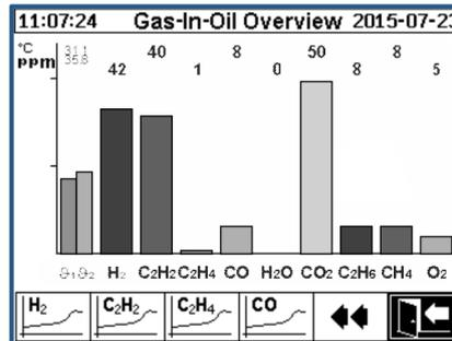
Diagrama individual para Hidrógeno (H<sub>2</sub>), Monóxido de Carbono (CO), Dióxido de Carbono (CO<sub>2</sub>), Metano (CH<sub>4</sub>) Acetileno (C<sub>2</sub>H<sub>2</sub>), Etileno (C<sub>2</sub>H<sub>4</sub>), Etano (C<sub>2</sub>H<sub>6</sub>), Oxígeno (O<sub>2</sub>) y Humedad (H<sub>2</sub>O).
