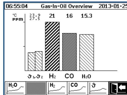
Diagrama de barras para hidrógeno (H<sub>2</sub>), monóxido de carbono (CO), humedad en aceite (H<sub>2</sub>O) y temperaturas.
