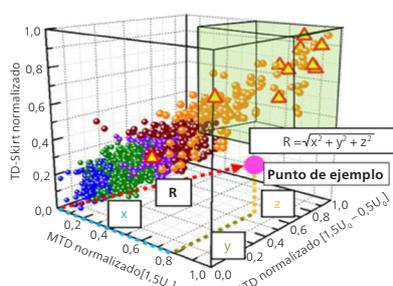
Tras la última medición y el recálculo del índice de envejecimiento R y basándose en el índice R de ambas mediciones, la velocidad de envejecimiento y la vida útil residual previsible del tendido de cable. Mediante la diferencia entre el límite operativo económico y el margen de seguridad específico de la empresa suministradora se puede deducir en qué momento deben realizarse trabajos en el tendido de cable.
