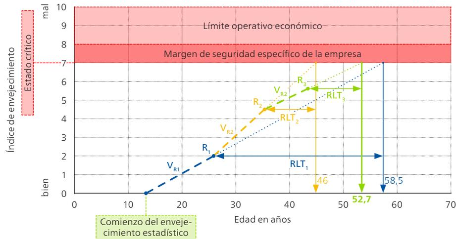
Una primera medición del factor de disipación tras un periodo de servicio DP (duty period) de 26 años da como resultado un valor de 2,0 para el índice de envejecimiento  $R_1$  del cable. Con ello se puede calcular la velocidad de envejecimiento  $V_{R1}$  después de la primera medición. Con la velocidad de envejecimiento se puede calcular la vida útil residual estadística RLT (remaining life time) del cable después de la primera medición.
