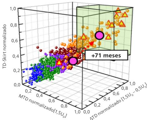
Representación 3D de las correlaciones entre los parámetros de evaluación normalizados de mediciones del factor de disipación MTD,  $\Delta$ TD y TD-Skirt. La zona enmarcada en la parte superior derecha de la imagen muestra una alta probabilidad de avería.
